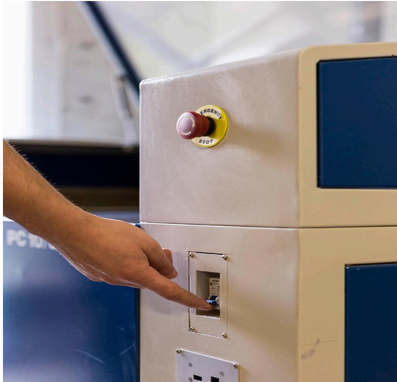
Appuie sur «origin ok» pour renvoyer la machine à son origine mécanique
