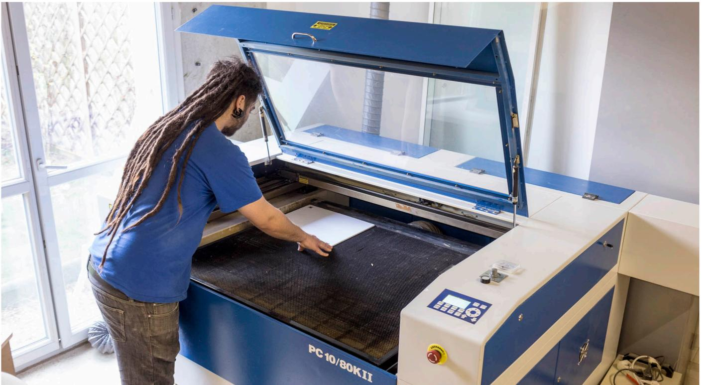
Avec les touches directionnelles, place la tête du laser au dessus de ton matériaux
