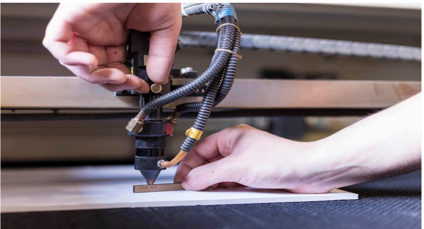
Positionne la tête du laser en haut à gauche de ton matériaux et appuie sur «XY->0» pour définir ton origine
